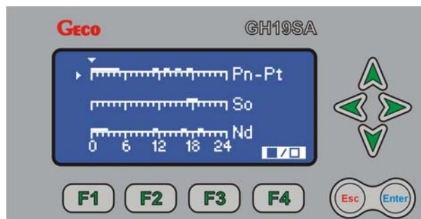
Rys. 3.2. Obraz pojawiający się na ekranie wyświetlacza LCD podczas ustawiania godzin pracy urządzeń zewnętrznych.
