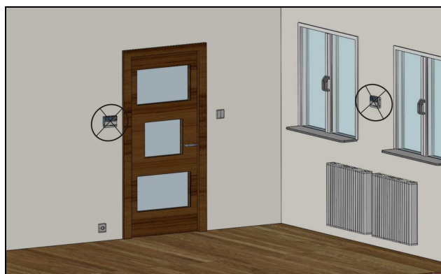
Rys. 1 Przykłady montażu panelu pokojowego GA03HA w pomieszczeniu
