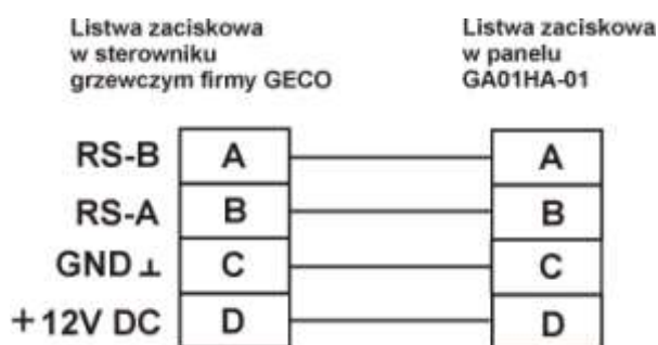
Rys. 1 Schemat podłączenia panelu pokojowego GA01HA do sterownika GH11RC
