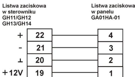
Rys. 1 Schemat podłączenia panelu pokojowego GA01HA do sterownika GH11TB
