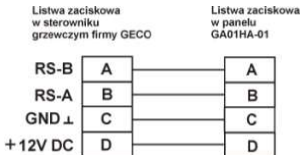
Rys. 1 Schemat podłączenia panelu pokojowego GA01HA do sterownika GH11MA
